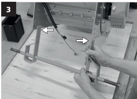
**BG** Повдигнете корпуса на машината от страната на пълнещия канал и закрепете оста на транспортното колело чрез четирите винта M8. Не затягайте винтовете.
