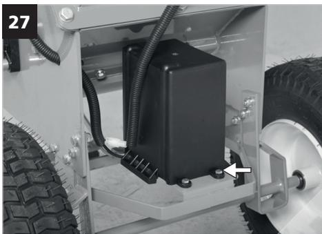
nainstalovaný). Akumulátor pripojte pomocou skrutiek + = červená, - = čierna. Nasuňte kryt akumulátora na základňu a prichytnite ho skrutkami k základni.
