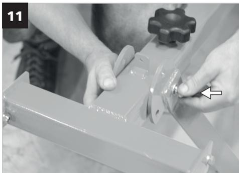
VG монтирайте предната опора на предната греда с вала (4x M8). Повдигнете машината от страната на канала за отстраняване и прикрепете предната греда с вала. Затегнете всичко.
